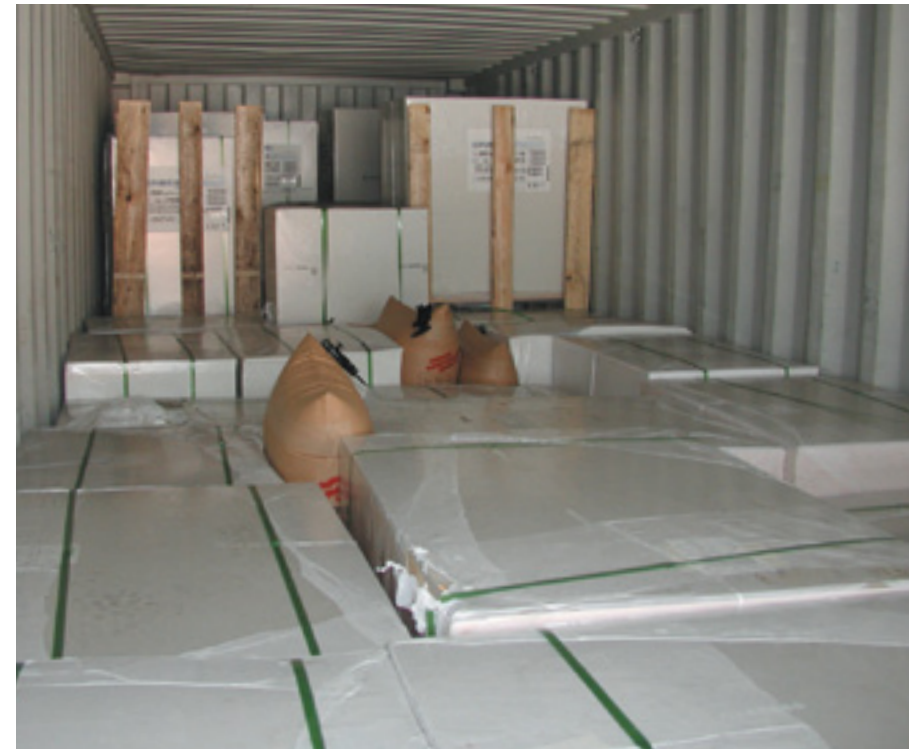
Stauung von uneinheitlichen Paletten: Die Zwischenraume sind mit Luftsacken ausgefullt. Die Paletten in der zweiten Lage sind jeweils durch drei Stucke Stauholz vor dem Verrutschen in Richtung Tur gesichert
