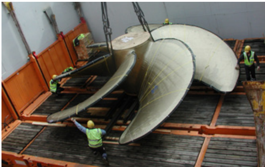
Laden eines großen Schiffspropellers mit einem Gewicht von 80 Tonnen. Der Propeller hat eine sehr kleine Auflagefläche. Daher wird eine starke Stahlbettung verwendet. Gelascht wird mit Stahldraht oder Gurten
