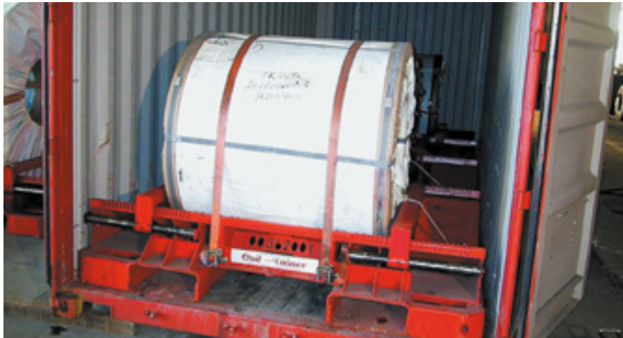
Stahlrolle, gesichert auf einem Gestell von Coil-Tainer
